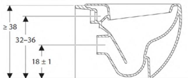
Figure 1 Zones de raccordement/critères de sélection pour montage à fleur du mur des WC au sol
